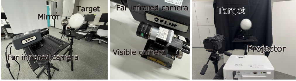
図8 実験の様子. 左から順に, (a) 撮像の様子, (b) カメラのシステム構成, (c) 投影のシステム構成.
