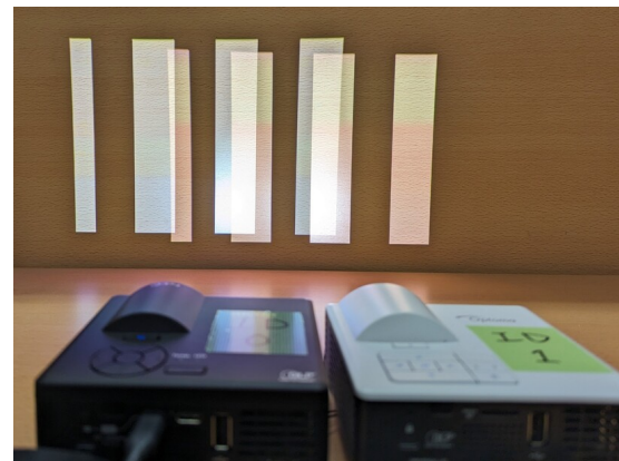
図 1: 複数台プロジェクタでの同時グレイコードパターン投影。重なりあったパターンを分離しなければ、それぞれのプロジェクタを独立に較正することができない。
