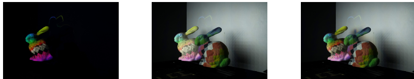
図9 カラープリントバニーを置いた明環境下での PM. PM のみ (1 列目). 全点灯した照明下での PM (2 列目). 光線制御した照明下での PM (3 列目).
