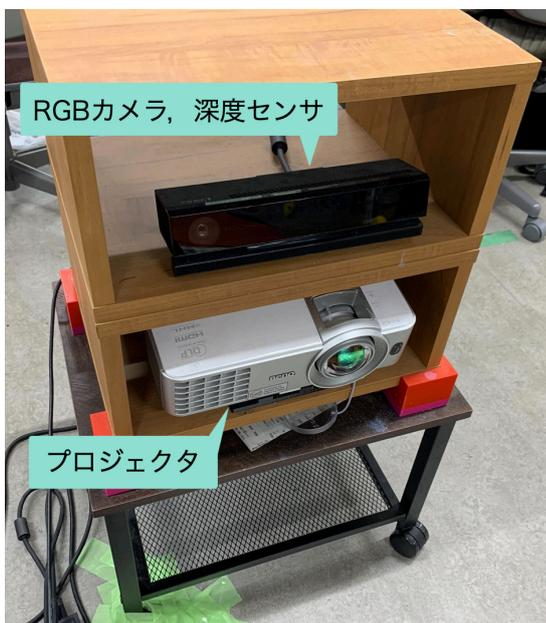
図3 プロジェクタカメラシステム
