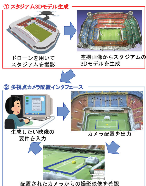
図1 大規模空間における多視点カメラ配置計画のためのVRインタフェース
