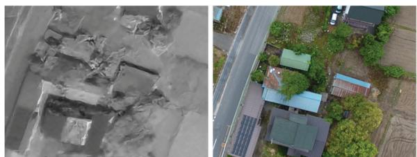
図 9 6 倍超解像画像(左)と同地点の HR 画像(右)
